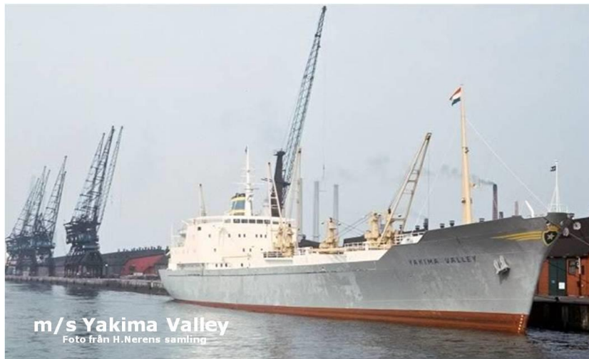
Första nybygget som Kapten Torsten Johansson hade, m/s Yakima Valley , först ut i serien om 6 kylfartg. Byggt på Lindholmen 1963.
